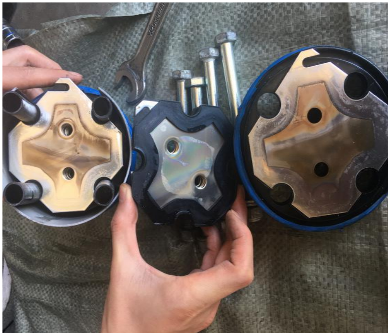
Рисунок 3.15 - Процесс очистки генератора водорода
