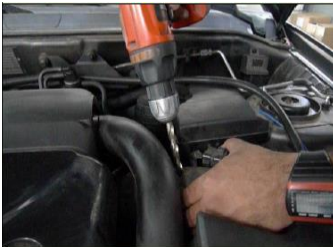
Рисунок 3.6 - Просверлите отверстие 8 мм близко к впускному коллектору
